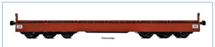
6-achsiger Schwerlastwagen Bauart Sas 4850 der DR (Epoche IV) mit abgeklappten Bordwänden, 2. Betriebs-Nummer
