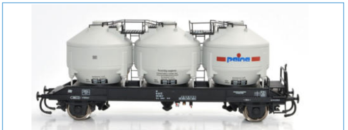
2-achsiger Silowagen Bauart Uc-y der Peine AG HYDRATKALK (Epoche V) zum Transport von Kalk
