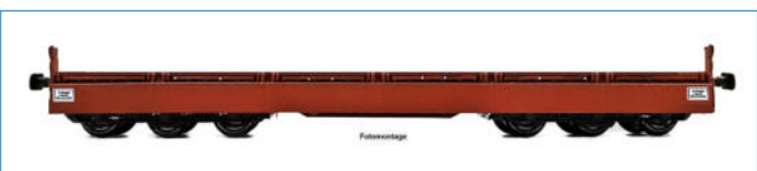
6-achsiger Schwerlastwagen Bauart Sas 4850 der DR (Epoche IV) mit abgeklappten Bordwänden, 1. Betriebs-Nummer
