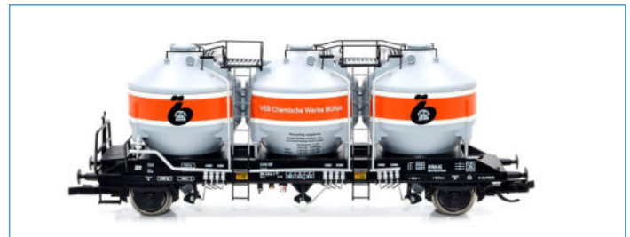
2-achsiger Silowagen Bauart Uc-y der DR VEB Chemische Werke BUNA (Epoche IV) zum Transport von Kunststoffgranulaten
