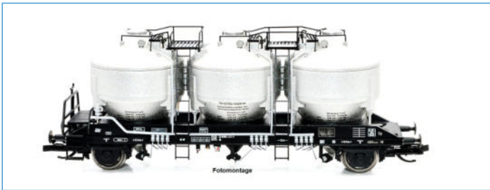
2-achsiger Silowagen Bauart Zk der DR (Epoche IV) zum Transport von Kunststoffgranulaten NW 52102 DC 2L TT 54,90 €
