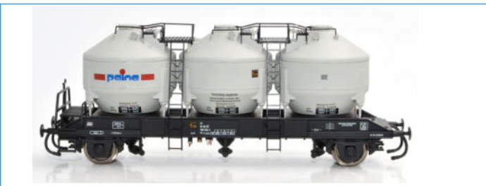
2-achsiger Silowagen Bauart Uc-y der Peine AG (Epoche V) zum Transport von Kalk
