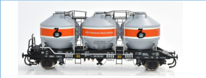
2-achsiger Silowagen Bauart Uc-y der DR VEB Chemische Werke BUNA (Epoche IV) zum Transport von Kunststoffgranulaten
