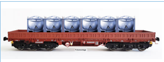
6-achsiger Schwerlastwagen der Bauart Samms 4860 der DR (Epoche IV) beladen mit Chemietanks Chemische Werke Buna
