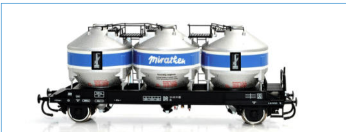
2-achsiger Silowagen Bauart Zk der DR Miratex (Epoche III) zum Transport von Kunststoffgranulaten
