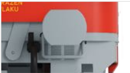
Separat angesetzte Griffe unter den Puffern
