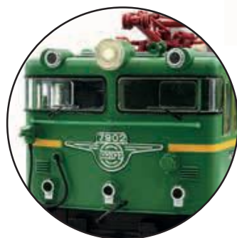
Luces frontales con foco superior independiente
