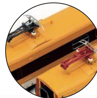
Diferentes pantógrafos para cada versión
