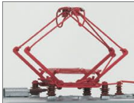
Mit heb- und senkbaren neu konstruierten Stromabnehmern der Bauart DBS 54
