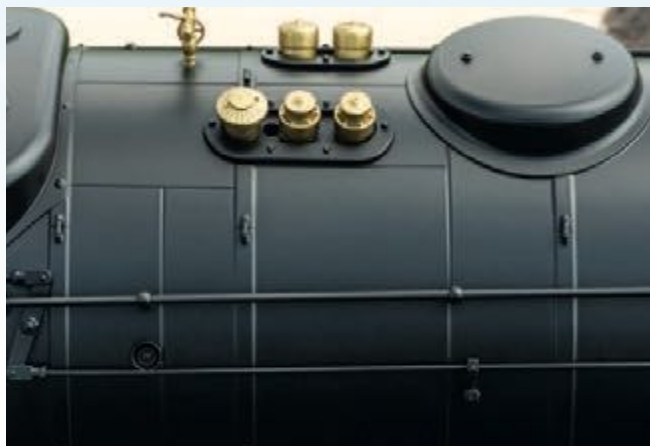
Die Sicherheits-Ventile wurden beim Modell – dem Vorbild entsprechend – aus Messing gefertigt
