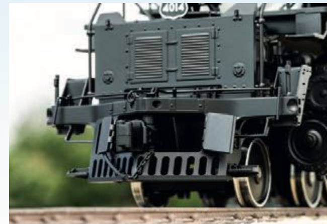
Die Frontkupplung ist raffiniert hinter zwei Klappen im Schienenräumer versteckt
