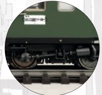
Vorbildgerecht mit Drehgestellen Minden- Deutz (MD) schwer Bauart 330 mit Kardanachsgenerator Bauart D 150
